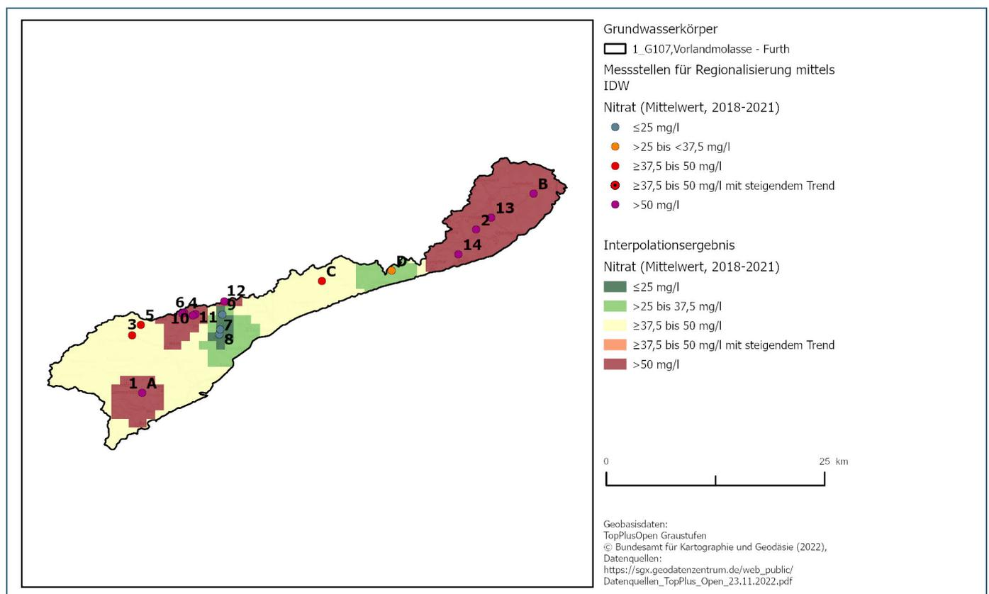
Abb. 4: Ergebnis der Interpolation mit dem Verfahren IDW
